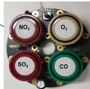
Электрохимические ячейки для измерения газа
